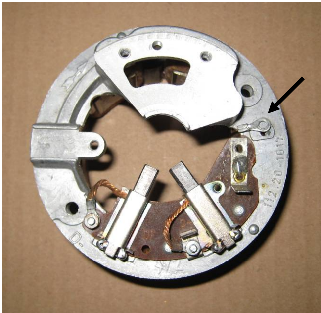
Reglerwiderstand abgeschraubt Feldkabel lose (Pfeil)
