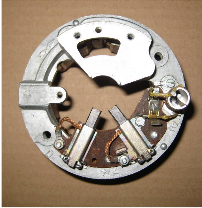
MZ TS Lichtmaschine, Ausgangszustand
